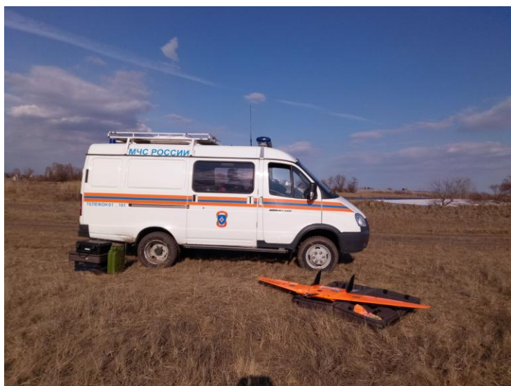
Рис. 2. БЛА Supercam S-250 в собранном виде
