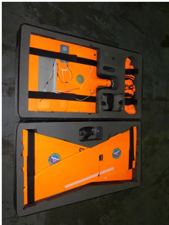
Рис. 4. БЛА Supercam S-250 в транспортируемом состоянии
