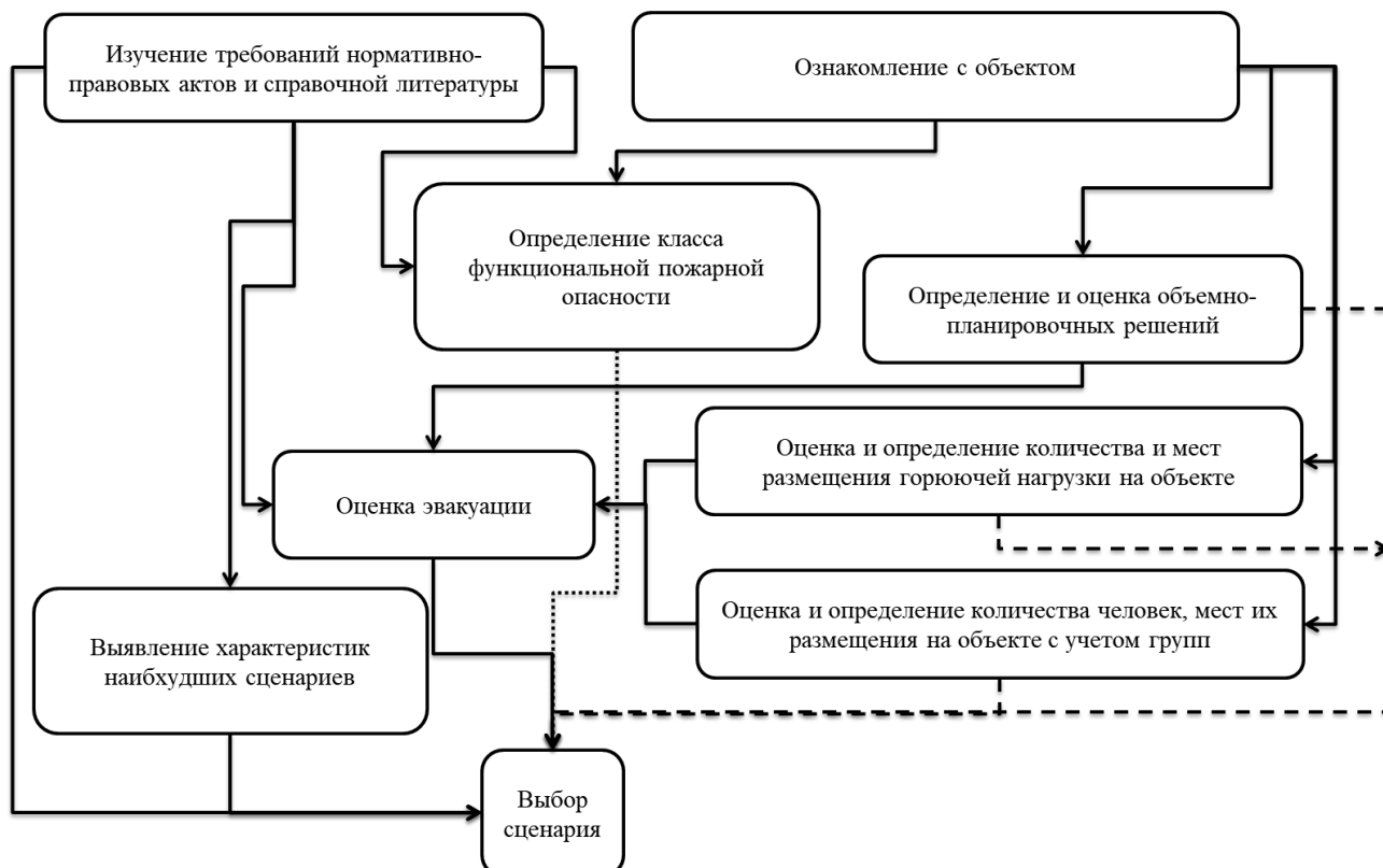
Рис. 2. Структурная схема определения наихудших сценариев развития пожара
