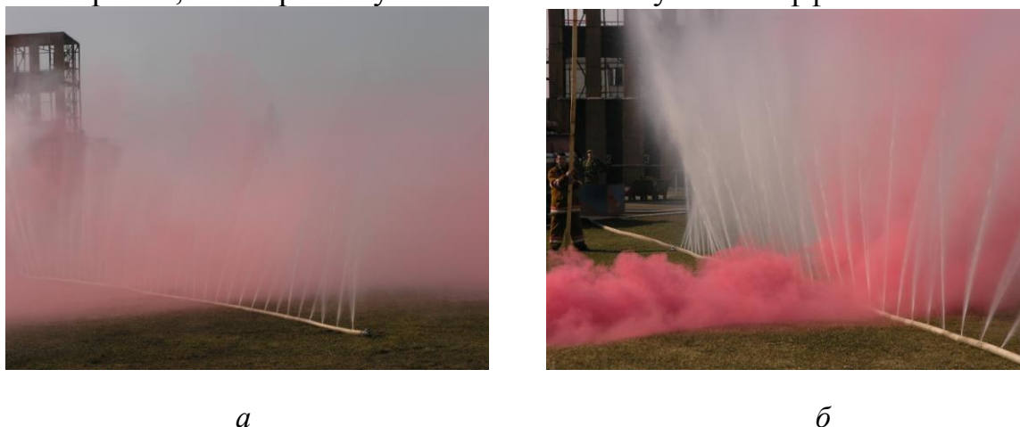
Рис. 1. Взаимодействие потока примеси с водяной завесой
