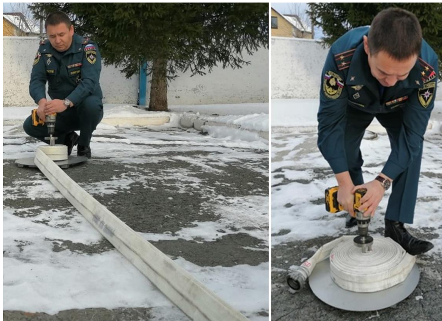
Рис. 2. Процесс формирования скатки напорного рукава опытным образцом технического решения
